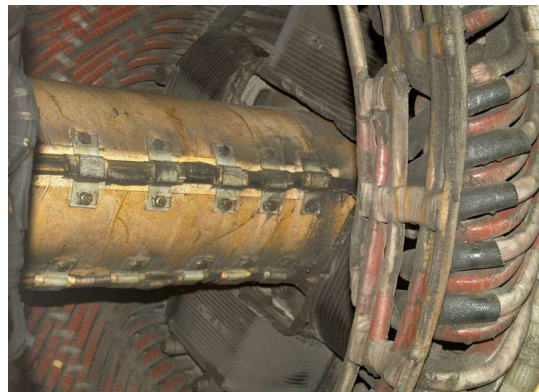
Particolare alternatore – avvolgimenti statorici e rotorici
