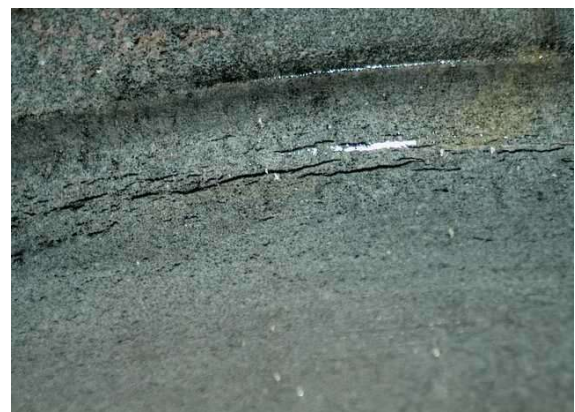
Magnetoscopia del perno – particolare delle cricche
