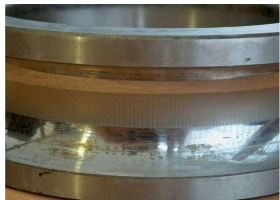
Particolare del cuscinetto danneggiato
